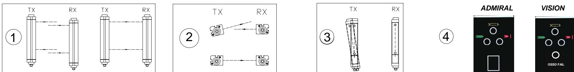
**I** Posizionare l'asse ottico del primo e dell'ultimo raggio dell'Emettitore sullo stesso asse di quello dei corrispondenti raggi sul Ricevitore.
